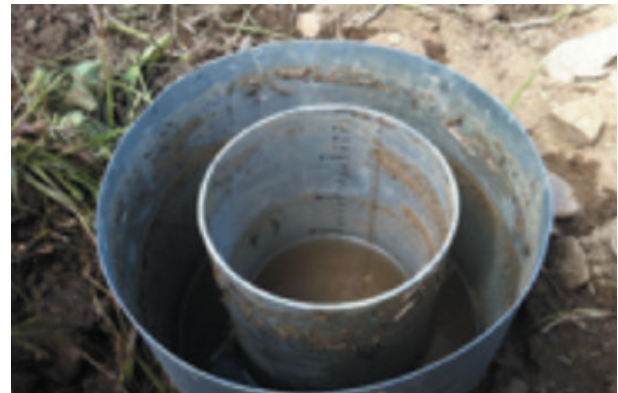
Imagen de un ensayo para determinar la capacidad de infiltración de un suelo.
